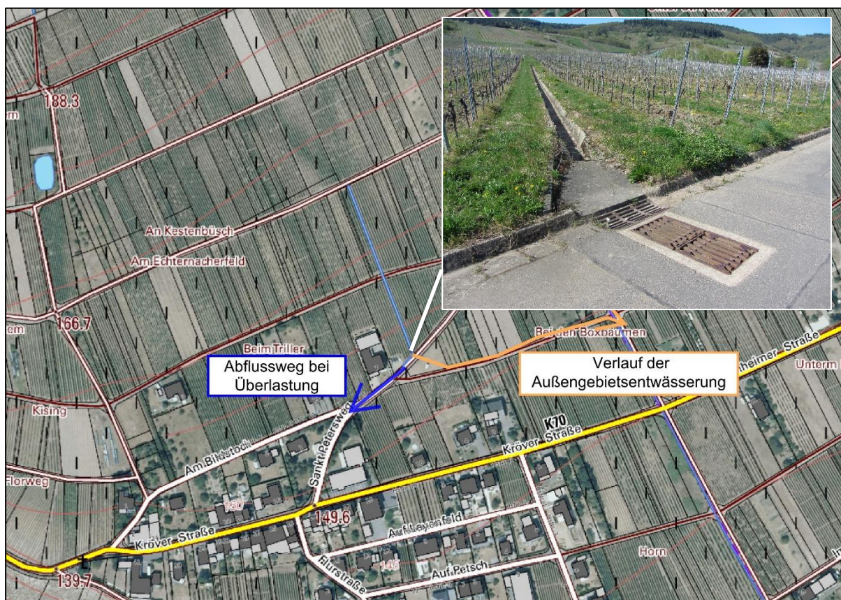
Abbildung 69: Außengebietsentwässerung am Sankt-Petersweg
