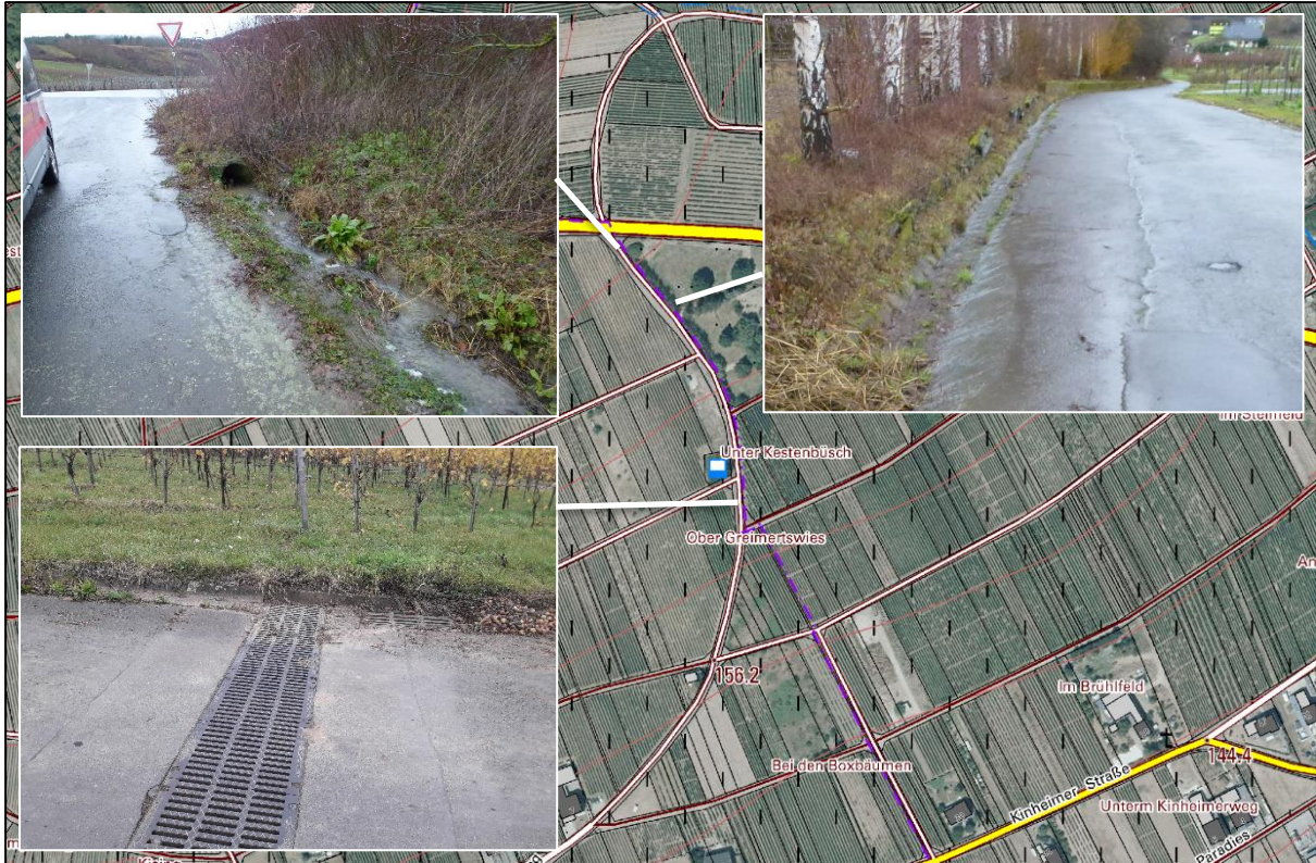
Abbildung 67: Entwässerungssystem auf dem Wirtschaftsweg ab der L58
