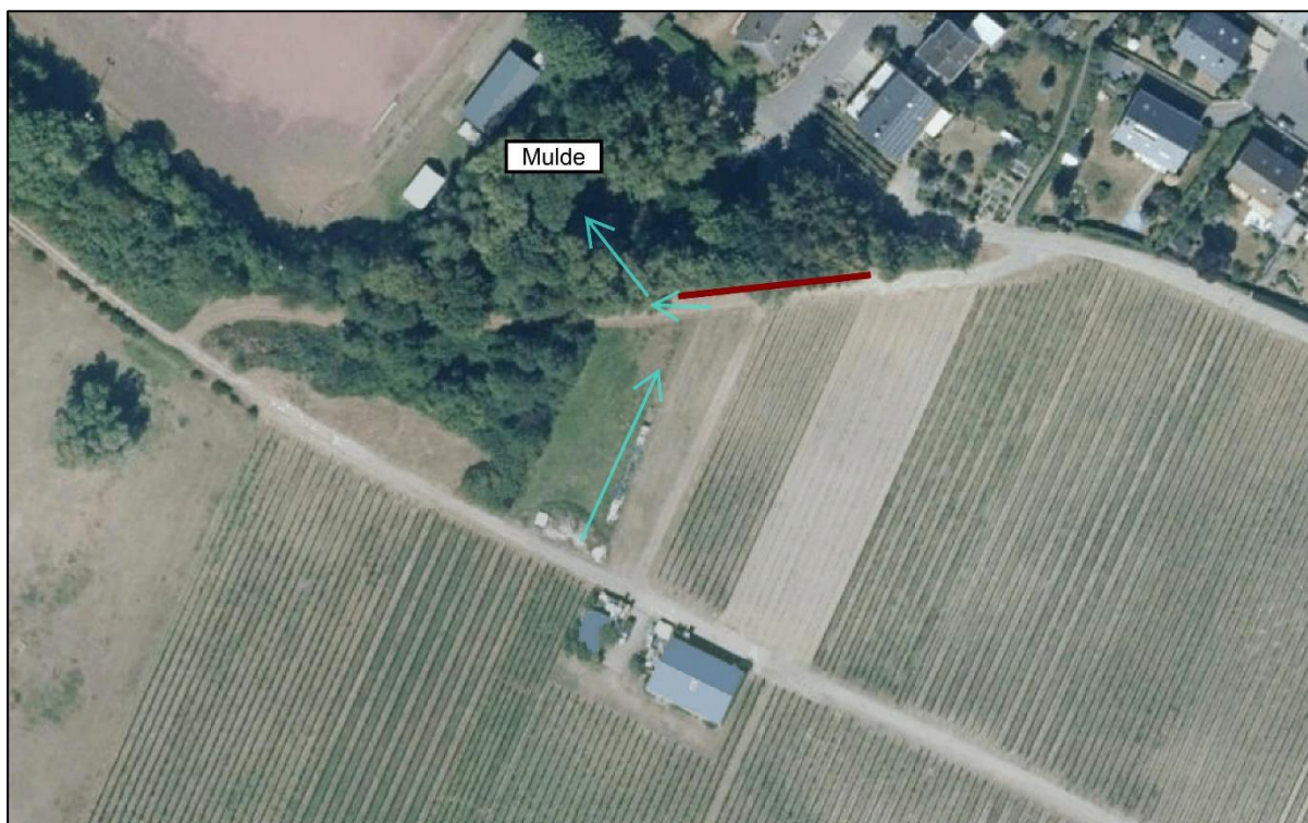
Abbildung 81: Gezielte Einleitung des Oberflächenwassers
