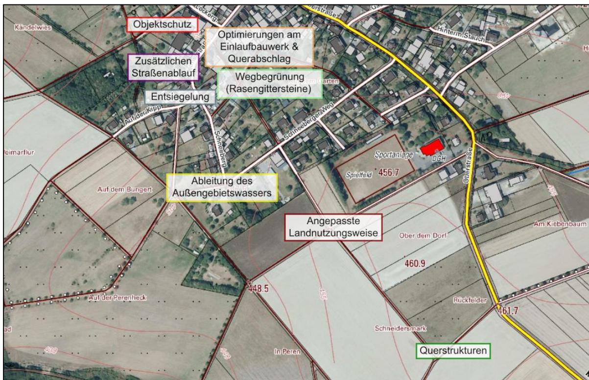
Abbildung 44: Maßnahmenübersicht für die Weimerstraße und den Verbindungsweg
