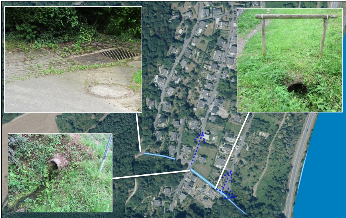
Abbildung 55: Wasserführung der Tiefenlinie mit potentiellen Fließwegen bei einer Überlastung
