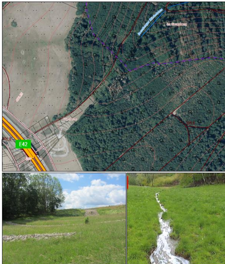
Abbildung 93: Regenrückhaltebecken B50 – Steinriegel (unten links, eigenes Foto), Erosionsrinne (unten rechts, Foto: Langer)
